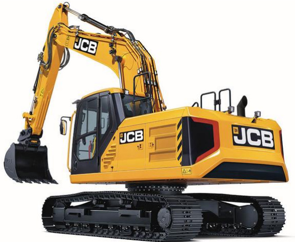
Rückbau mit einem ca. 20 to. Kettenbagger
